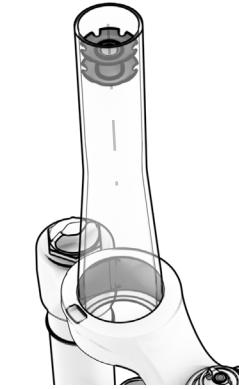
⚠ Es ist ratsam, einen Abzieher zu verwenden, um sicherzustellen, dass der Zahnkranz perfekt ausgerichtet in den Gabelschaf eingesetzt wird.
