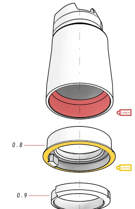
! Das Teil 0.8 kann mit der zum Rahmen zeigenden Kerbe montiert werden, aber das Teil 0.9 muss immer im Verhältnis zur Position der ersten montiert werden, wie in den Abbildungen dargestellt.
