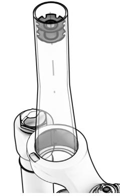
**⚠** Es ist ratsam, einen Abzieher zu verwenden, um sicherzustellen, dass der Zahnkranz perfekt ausgerichtet in den Gabelschaft eingesetzt wird.
